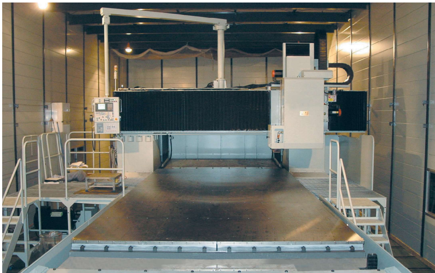
研削用永磁チャック(大形サイズの製作例)
