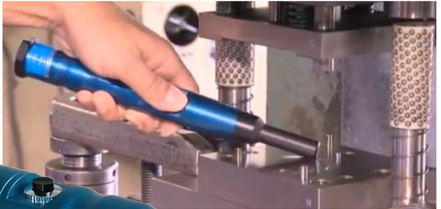
金型突起部の脱磁作業例
