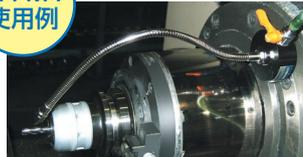
**用途** 工作機械への切削油またはエアの供給に使用します。また、放電加工における隙間のチップや微粉を加工液噴射で除去することにも利用できます。
